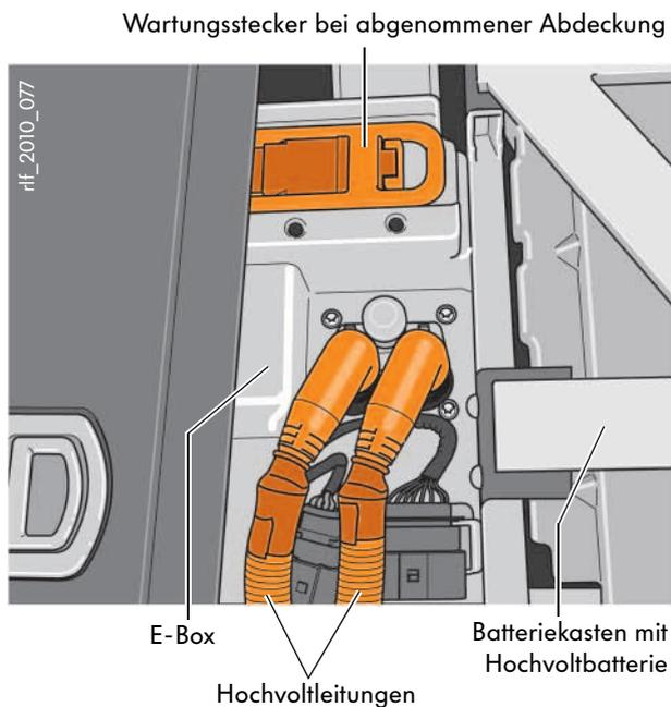
**Abb.: E-Box im Kofferraum neben der Hochvoltbatterie**
