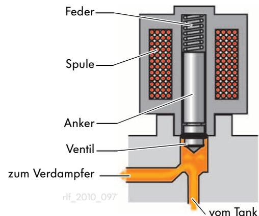
Abb.: Funktion der Ventile für Tankabsperung
