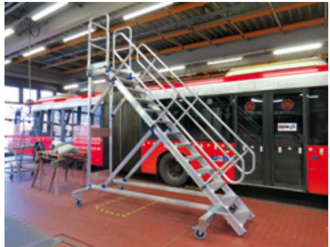
Abbildung 4/4: Mobiler Dacharbeitsstand
