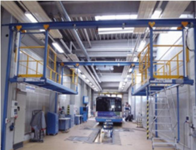
Abbildung 4/6: Stationärer Dacharbeitsstand
