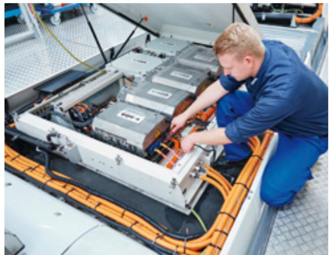
Abbildung 4/9: Feststellen der Spannungsfreiheit auf dem Dacharbeitsstand
