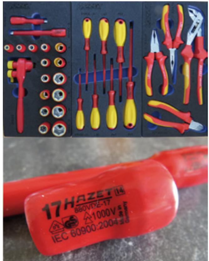
Abbildung 4/13: Isoliertes Werkzeug nach DIN EN 61477 und DIN EN 60900
