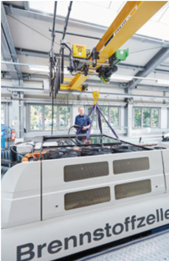
Abbildung 4/12: Fest installierter Kran auf dem Dacharbeitsstand
