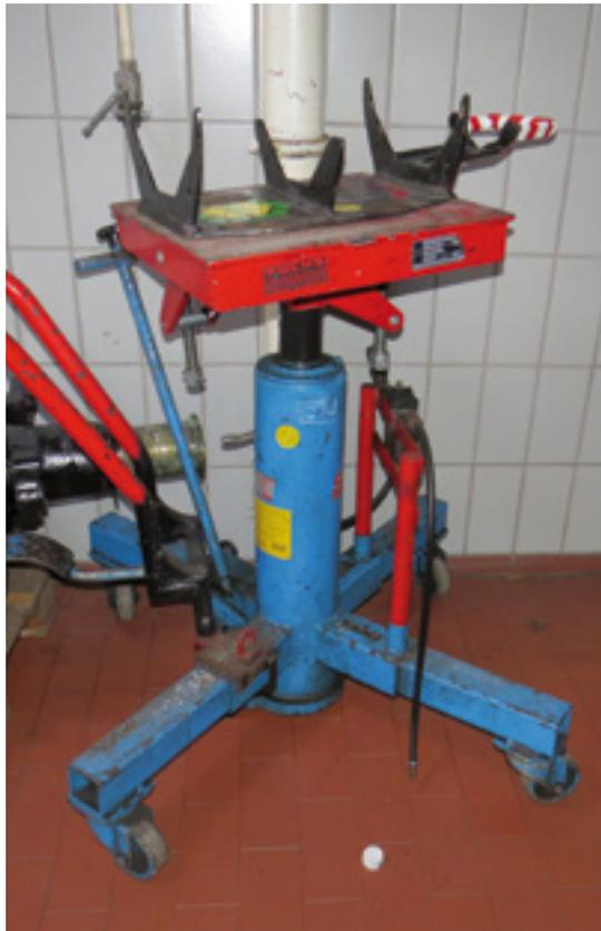
Abbildung 4/10: Mobil einsetzbarer Aggregatheber
